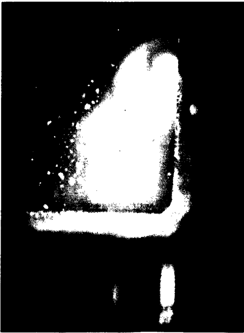
FITC標識rHSAシート(金基板上)
