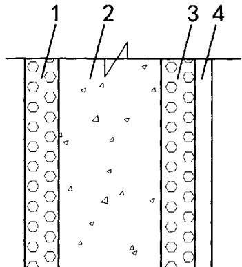
1. 一种复合保温系统,由基层墙体(2)内侧的内保温层(1)和基层墙体(2)外侧的外保温层(3)以及外保温层(3)外侧的反射隔热涂料饰面层(4)构成。
