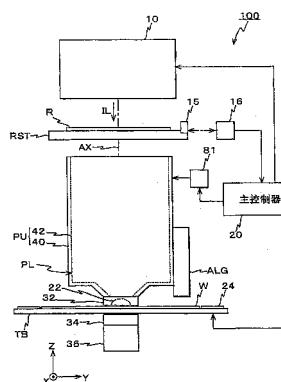
1. 一种曝光装置，该曝光装置在投影光学系统和衬底之间的空间中供给液体，用能量束照射图案，并通过所述投影光学系统和所述液体将所述图案转印到所述衬底上，所述曝光装置包括：
