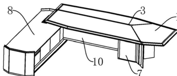
1. 一种具有装饰结构的桌子,其特征在于,包括桌面本体(1),所述桌面本体(1)的表面上凹设有将表面分隔成若干区域的凹槽(2),所述凹槽(2)内嵌装有装饰条(3),所述桌面本体(1)包括底层板(4)、设置在底层板(4)上的中层板(5)、以及若干拼板(6),所述拼板(6)设置在中层板(5)上,相邻拼板(6)之间设有间隙以形成所述凹槽(2)。
