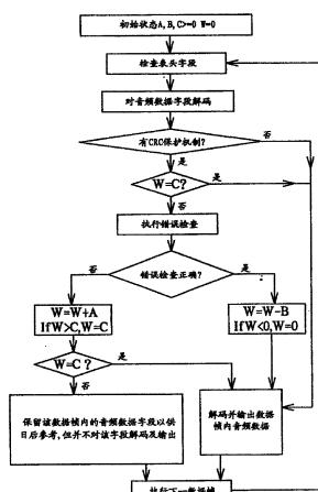
1. 一种利用控制装置的媒体文件再生方法，该媒体文件包含多个数据帧，每个数据帧都有一错误检查字段，以及一用以存储已编码音效样本的音效数据字段，该控制装置包括一参数，该方法包含有：
