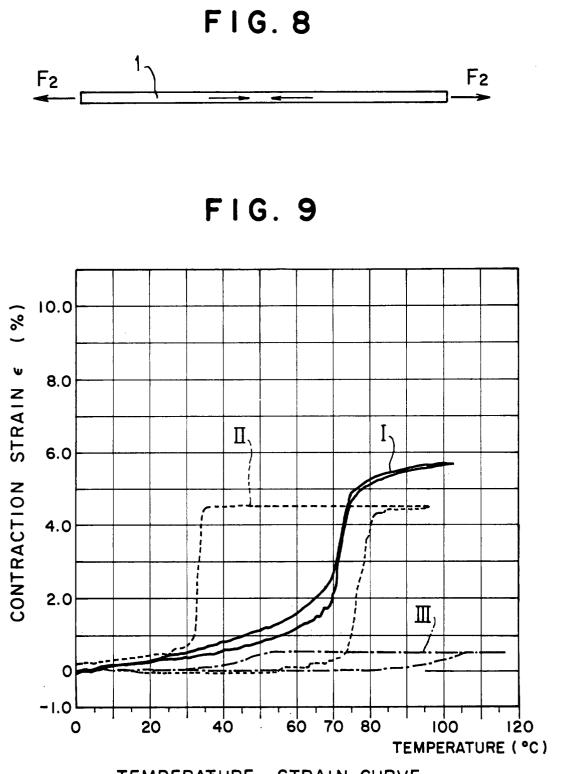
TEMPERATURE - STRAIN CURVE
