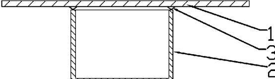
1. 一种茶几，其结构包括玻璃板，其特征是，在玻璃板的下方设有支撑玻璃板的鱼缸，所述的鱼缸为顶面开口的玻璃盒，鱼缸的顶面设有至少三个吸盘，所述的玻璃板面积大于鱼缸的顶面面积，玻璃板通过吸盘与鱼缸固定。
