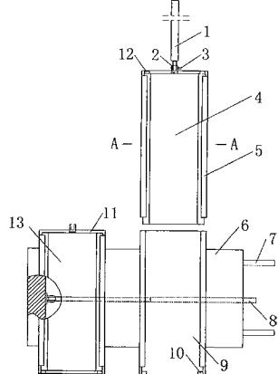
1. 一种双纵剪机原位交换装置,包括推移缸、安装台、固定工位座、移位台、滑轨、换位缸、第一工位座和第二工位座;其特征是:固定工位座、第一工位座和第二工位座上均带有轨道,固定工位座上安装有安装台;推移缸安装在固定工位座一侧;第一工位座和第二工位座均安装在移位台上,其中的一个工位座上也安装有安装台,移位台通过滚轮安装在两条滑轨上,两条滑轨之间设置有换位缸,移位台与换位缸的活塞杆连接。
