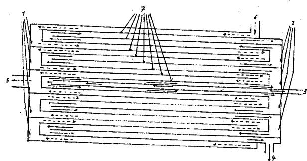
Die Erfindung betrifft einen Wärmetauscher bei dem zwei voneinander durch Trennwände getrennte Strömungswege für zwei Fluide vorgesehen sind, wobei die Trennwände an einer Seite von dem aufzuwärmenden und an der anderen Seite von dem abzukühlenden Fluid umströmt werden.
