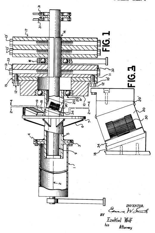
TORSIONALLY OSCILLATING ROTATING ROLL
