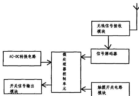
1、一种具备学习功能的遥控触摸感应开关，包括无线信号发射器和开关本体，所述开关本体包括壳体，所述壳体外表面设有触摸屏，所述触摸屏连接有触摸开关电路模块；所述开关本体的壳体内还设有微处理器控制单元，所述微处理器控制单元与供电电路间通过 AC-DC 转换电路相连接；所述微处理器控制单元分为信号输入端和信号输出端，所述微处理器控制单元的信号输入端的引脚上分别连接有触摸开关电路模块和无线信号接收模块，所述微处理器控制单元的信号输出端的引脚上连接有开关信号输出模块，所述开关信号输出模块通过电路与该开关所控制的负载相连接；所述无线信号发射器包括有面板，所述面板上设有两个或两个以上的按键，所述面板底部电路连接有按键信号输入模块，所述按键信号输入模块电路与微处理器控制模块的信号输入端的引脚电路连接，所述微处理器控制模块的信号输出端与无线信号发射模块相连接；其特征在于：所述开关本体内还设有信号解码器，所述信号解码器电路连接于所述无线信号接收模块与所述微处理器控制单元之间；所述无线信号发射器内还包括有高频震荡调制模块，所述高频振荡调制模块设于所述微处理器控制单元的信号输出端与无线信号发射模块之间。
