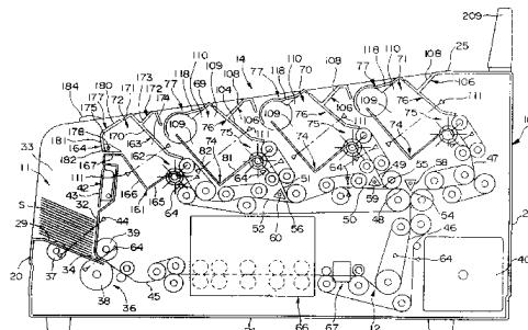
1. 一种纸币整理机，包括：在装填纸币的同时将所装填的纸币一张一张地输出的装填装置；输送从该装填装置中输出的纸币的输送装置；对该输送装置输送中的纸币进行鉴别的鉴别装置；能够取出地集聚由前述输送装置输送的纸币的多个集聚装置；从决定装填到前述装填装置中的纸币的分类方法的多种分类处理模式中选择出一种分类处理模式操作的操作装置；根据前述鉴别装置的鉴别结果，由输送装置将从前述装填装置中输出的纸币输送到与由前述操作装置所选择的分类处理模式相对应的前述多个集聚装置中之一内的控制装置；其特征在于，
