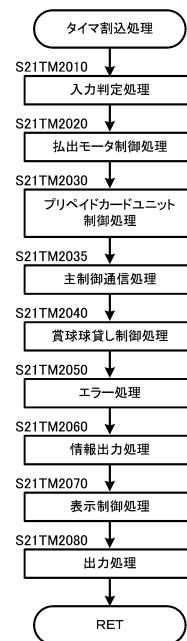
【図9-24】 払出制御タイマ割込処理
