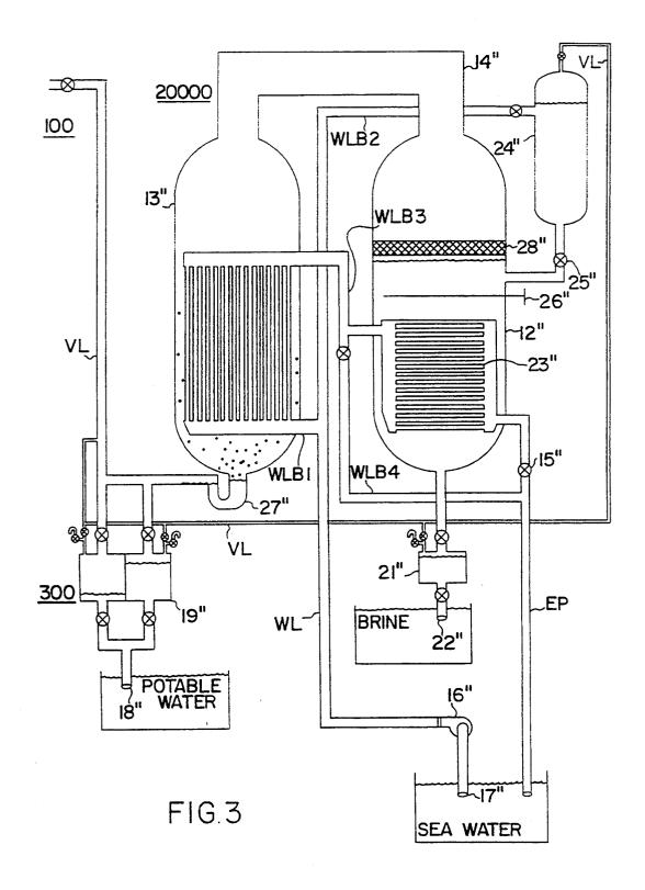
LIQUID PURIFYING AND VACUUM DISTILLATION PROCESS
