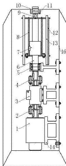
1. 一种行星滚柱丝杠副的加载装置，其特征在于包括压力加载和拉力加载两部分；压力加载部分包括依次同轴连接的伺服电机(1)、下联轴器(2)、扭矩传感器(3)、上联轴器(4)、轴承(5)、丝杠(6)、螺母(7)、套筒(8)、压力传感器(9)、托盘(11)、砝码组(10)；伺服电机(1)、下联轴器(2)、扭矩传感器(3)、上联轴器(4)、轴承(5)、丝杠(6)、螺母(7)、套筒(8)、压力传感器(9)、托盘(11)从下往上依次布置在箱体型工作台(16)中；套筒(8)的两端挡板分别与相互平行的两个圆柱直线导轨(13)连接；直线位移传感器(12)安装在圆柱直线导轨(13)的一侧；托盘(11)固定在压力传感器(9)上顶面，砝码组(10)放置在托盘(11)上；伺服电机(1)通过下联轴器(2)和扭矩传感器(3)相连；扭矩传感器(3)通过上联轴器(4)和丝杠(6)相连；伺服电机(1)通过支撑架(14)固定连接在工作台(16)上。
