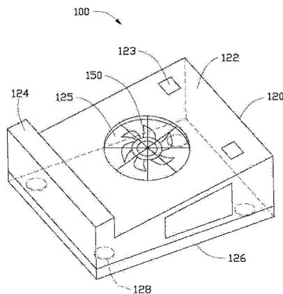
1. 一种笔记本电脑底座,包括一壳体及一设于所述壳体内的防盗电路,所述壳体的顶面设有若干用于支撑一笔记本电脑的支撑垫,所述防盗电路包括一第一弹性开关、一控制开关、一报警装置及一电池组,所述第一弹性开关与所述控制开关及报警装置串联连接在所述电池组的两端,所述第一弹性开关设于一支撑垫上,所述笔记本电脑置于所述笔记本电脑底座上时闭合所述控制开关,当所述第一弹性开关未受到所述笔记本电脑的压力时,所述第一弹性开关闭合,所述电池组给所述报警装置供电,所述报警装置报警。
