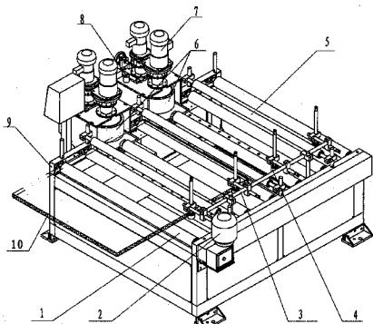
1. 一种板材侧面涂布机,包括设置在机架(9)上的若干输送辊(1),输送辊(1)与输送电动机(2)连接并能够被输送电动机(2)带动而转动,板材(10)放置在输送辊(1)上并能够随着输送辊(1)的转动而沿着规定的方向运动;其特征在于:在机架(9)的一侧设有用于对板材(10)的侧面定位的若干侧挡辊(4),在机架(9)的另一侧设有至少一个涂布胶辊(6),涂布胶辊(6)与涂布电动机(7)连接并能够被涂布电动机(7)带动而转动,涂布胶辊(6)的安装架上设有注胶口(8)。
