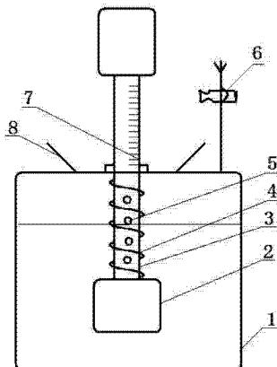
1. 一种注水大罐内液面精确测量数控摄像装置,该装置有注水大罐(1)、浮子(2)、中心管(3)、弹簧(4)、泄压孔(5)、数控摄像头(6)、刻度尺(7)、防溢流挡板(8)组成,其特征是:在注水大罐(1)的内腔设置浮子(2),在浮子(2)的顶部设置中心管(3),在中心管(3)的外侧设置弹簧(4),在中心管(3)的下部四周设置泄压孔(5),在中心管(3)的上部设置刻度尺(7),在刻度尺(7)的一侧设置数控摄像头(6),在刻度尺(7)的四周设置防溢流挡板(8)。
