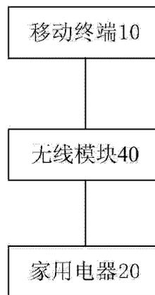
1. 一种家用电器的控制系统,其特征在于,包括移动终端、无线模块和家用电器,其中,所述移动终端具有陀螺仪,所述移动终端通过所述陀螺仪采集用户针对所述移动终端输入的手势动作,并根据所述手势动作生成控制指令;
