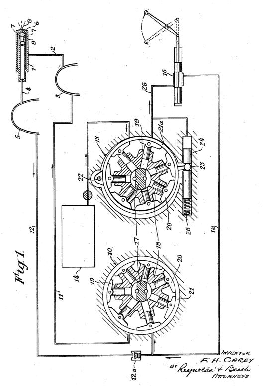
FUEL SUPPLY SYSTEM FOR SPILL TYPE BURNERS
