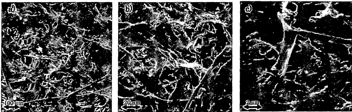
Abbildung 7: Rasterelektronenmikroskopieaufnahmen Tissue-Papier Saugstark & Sicher; Vergrößerungen: a) 100x, b) 500x, c) 5.000x (siehe Beispiel 23).
