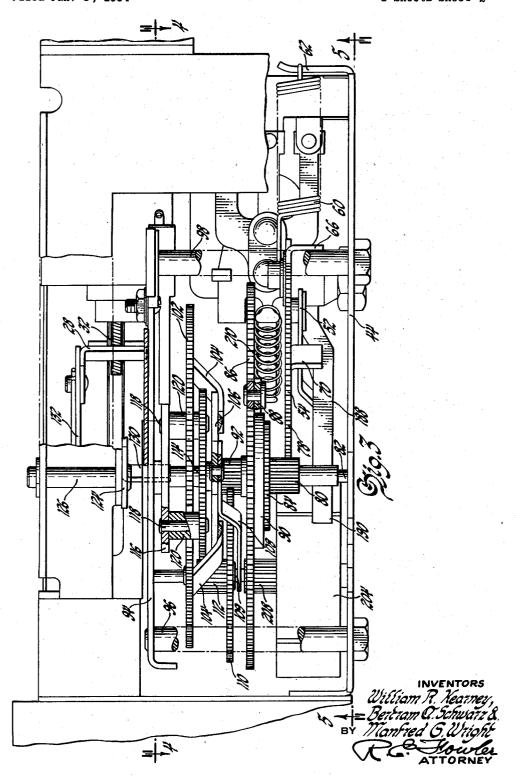
SOLENOID DRIVEN TUNER WITH MANUAL DRIVE
