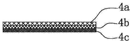
1. 一种脚背透气式皮鞋,包括鞋帮(1)、鞋底(2)和鞋跟(3),所述鞋帮(1)由皮革制成,其特征在于:在所述鞋帮(1)的前部从前往后设有多个开口,该开口从鞋底(2)的左侧延伸至右侧,并在每条开口处设置有与之形状大小相适应的橡胶带(4),所述橡胶带(4)由外层橡胶带(4a)、中层橡胶带(4b)和内层橡胶带(4c)叠置而成,在每层橡胶带上均密布有透气孔,且外层橡胶带(4a)上的透气孔孔径大于中层橡胶带(4b)上的透气孔孔径,中层橡胶带(4b)上的透气孔孔径大于内层橡胶带(4c)上的透气孔孔径。
