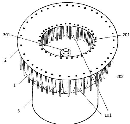
1. 一种风轮电极放电装置,包括风轮电极(1)、固定电极(2)和电机(3),固定电极(2)设有内环电极(201)和外环电极(202),风轮电极(1)的风轮叶片(101)设置在内环电极(201)与外环电极(202)中间,风轮电极(1)通过轴心上的电机/风轮电极接合点(301)固定在电机旋转轴上;其特征在于放电两组电极中,有一组电极被电机驱动旋转产生气流,另一组电极固定不动;风轮电极(1)是圆柱形结构,风轮叶片(101)与圆柱形风轮的旋转轴平行;内环电极(201)所构成的圆柱面和外环电极(202)所构成的圆柱面均与圆柱形风轮同轴。
