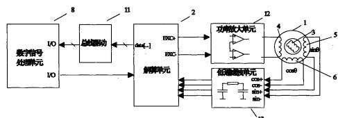
1. 一种永磁同步电机转子位置传感方法，采用旋转变压器和数字转换解算单元作为永磁交流伺服系统中的传感器，设有对所述解算单元进行控制并接受其解算结果的数字信号处理单元，所述解算单元从旋转变压器输出信号中解算出电机转子角度信息传送至数字信号处理单元，数字信号处理单元再控制逆变器，最后驱动永磁同步电机运转，其特征在于：
