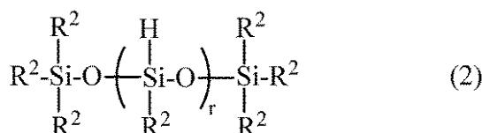
で示される側鎖に水素原子を有するオルガノシロキシ基と末端のトリオルガノシロキシ基のみで構成されたオルガノハイドロジエンポリシロキサンである。ここで、R<sup>2</sup>は独立して炭素数1～12の1価炭化水素基であり、前記R<sup>1</sup>で示された基と同じものが例示され、rは5～50の整数、好ましくは10～40の整数である。(E-1)成分は、(E)成分の全配合量の1～50質量%、好ましくは5～30質量%である。
