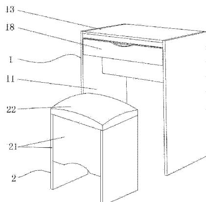
1. 一种梳妆桌椅，其包括桌子和椅子，其特征在于：所述桌子包括两个侧板、背板、第一桌面、第二桌面和支撑杆，所述两个侧板相向设置，背板固定在两个侧板之间；所述第一桌面的后侧边与背板的上端铰接，第一桌面的下表面设有镜子；所述第二桌面固定在两个侧板之间，且位于第一桌面的下方；所述两个侧板的内侧面上分别设有支撑块，支撑块设置在第一桌面和第二桌面之间，两个支撑块的上表面齐平；所述支撑杆设置在第二桌面的上方，支撑杆的一端与其中一个侧板的内侧面铰接，支撑杆的另一端与第一桌面的下表面铰接；所述第二桌面的下方设有抽屉，抽屉的两侧面分别滑动连接于两个侧板的内侧面。
