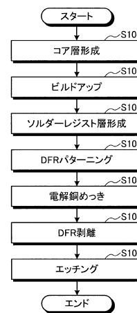
一実施の形態に係る主基板の製造方法を示すフロー図
