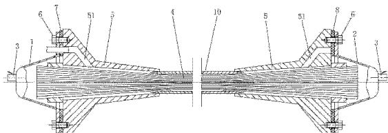
1. 一种用于预应力混凝土管道压浆施工的锚头密封装置,其特征在于:包括分别用于与所述管道(10)两端的锚垫板(5)密封连接的第一密封罩(1)和第二密封罩(2),所述第一密封罩(1)和第二密封罩(2)均设有用于排气的通断阀(3)。
