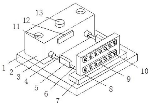
1. 一种猪养殖场用消毒设备,包括底板(1),其特征在于:所述底板(1)顶部的左侧固定连接有消毒箱(2),所述消毒箱(2)顶部的中端固定安装有电机(13),所述电机(13)的输出端固定连接有转动杆(15),所述转动杆(15)的左右两侧均固定连接有搅拌杆(14),且搅拌杆(14)交错设置,所述消毒箱(2)右侧的前后两侧均固定安装有水泵(3),所述水泵(3)的输出端固定连接有第一输水管(4),所述第一输水管(4)的输出端固定连接有雾化器(5),所述雾化器(5)的输出端固定连接有第二输水管(6),所述第二输水管(6)的输出端固定连接有排水板(8),所述排水板(8)右侧的上下两端均固定连接有输水板(9),且输水板(9)的正面固定连接有雾化喷头(10),所述排水板(8)的底部固定连接有底座(7),所述底座(7)的底部与底板(1)顶部的右侧固定连接。
