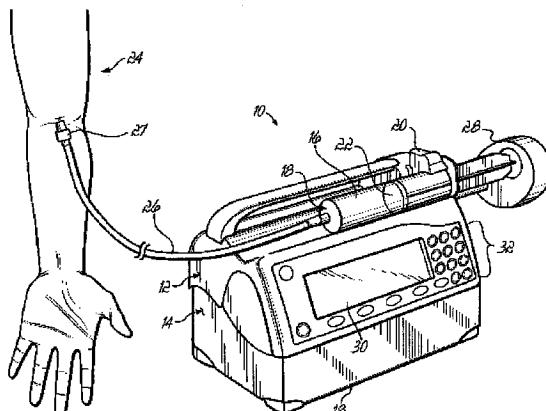
1. 一种使用医用泵 (10) 冲洗流体管 (26) 的方法, 所述医用泵 (10) 被配置用于在注射过程之后执行冲洗过程, 所述方法包括 : 响应于所述注射过程的终结, 以人工可检测的形式自动地查询是否继续进行冲洗过程, 直到进行所述注射过程之后, 所述冲洗过程与所述注射过程之间才存在指定关系。
