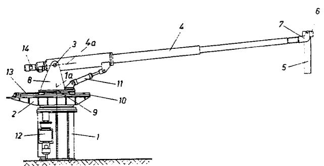
Die Erfindung bezieht sich auf einen Manipulator zum Ansetzen eines Gießrohres an den Ausgußschieber einer Gießpfanne mit einem um eine vertikale Achse drehbaren Kopf, auf dem ein Auslegerarm zur Aufnahme des Gießrohres um eine horizontale Schwenkachse drehbar gelagert und sowohl quer zur Schwenkachse als auch zur vertikalen Drehachse des Kopfes verschiebbar ist.
