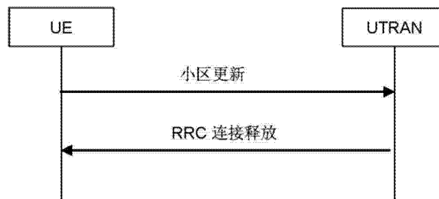
[0592] 图 8.3.1-7 :故障情况下的小区更新过程
