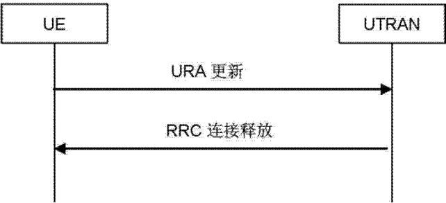
[0972] 图 8. 3. 1-10 :故障情况下的 URA 更新过程 [0973] 8. 3. 1. 1 概述
