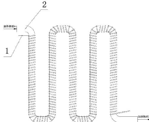
1. 一种电加热装置，包括导热管和电加热丝，电加热丝螺旋缠绕于导热管外壁，其特征在于：所述的导热管为铝合金管，铝合金管的外壁表面设置有一层硫酸阳极氧化膜；所述的电加热丝与铝合金管的外壁表面直接接触。。
