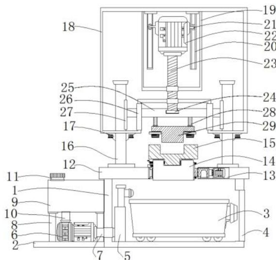
1. 一种带废料收集机构的五金冲压机,其特征在于,包括:冲压机底座箱(1),所述冲压机底座箱(1)的下底面固定连接有机箱底板(2),所述冲压机底座箱(1)的内部放置有废料收集装置(3),所述冲压机底座箱(1)的右侧外表面固定连接有废料出入口(4),所述冲压机底座箱(1)的内部左侧表面固定连接有清洗杆(5),所述机箱底板(2)的左侧表面固定连接有水泵(6),所述水泵(6)的右侧表面固定连接有第一水管(7)连接于所述清洗杆(5)的左侧,所述水泵(6)的左右两侧均固定连接有水箱支撑杆(8),所述水箱支撑杆(8)的上侧固定连接有水箱(9),所述水箱(9)的下底面固定连接有第二水管(10),所述水箱(9)的上表面固定连接有加水口(11)。
