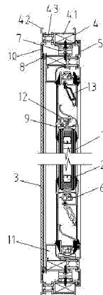
1. 一种防水窗框铝合金门窗节点,其特征在于:包括固定设置于墙面的窗框以及固定设置在窗框上的窗扇,所述窗扇上还安装有玻璃支撑架,所述玻璃支撑架上安装有双层玻璃,所述双层玻璃之间设置有间隙,所述双层玻璃之间的间隙通过第一密封胶条密封,所述窗扇靠近室内的一侧还设置有单层变色玻璃;所述窗框包括铝合金柱状型材和铝合金片状型材,所述铝合金柱状型材和铝合金片状型材之间通过拉筋连接在一起;所述铝合金片状型材上还设置有防水隔热条安装插槽。
