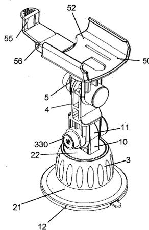
1. 一种吸盘式支撑臂架的改良，其特征在于，其主要由吸盘体、盘架座、旋锁推顶装置及承置固定座所组合而成；所述吸盘体为一顶部具有多边形凸起支架杆，底部为橡胶吸盘的吸附座体；所述支架杆底部外缘成螺杆体，顶部具枢接端头；所述盘架座中央具供支架杆穿过的通孔，底部成硬壳式盘体；在所述盘架座外，套置一内具螺纹能与所述支架杆螺杆体螺锁的旋锁推顶装置，所述盘架座上锁接一盖板，所述盘架座的支架杆顶部的枢接端头枢接一能组接固置物的承置固定座。
