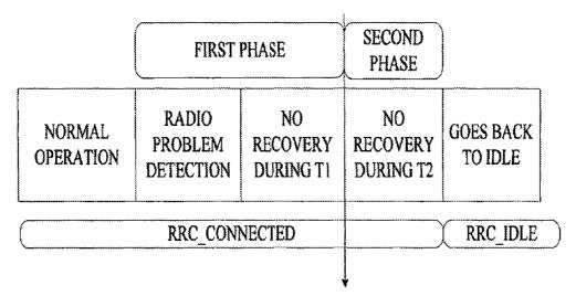
RADIO LINK FAILURE
