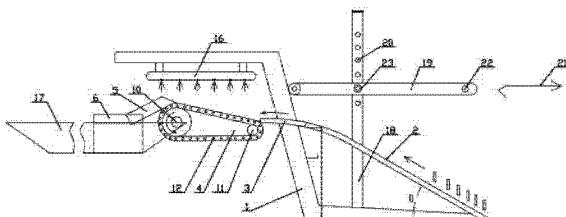
1. 一种收蛏机，它主要包括支架体、起蛏器、导板、输送装置、出料槽和收集箱，其特征在于：所述起蛏器倾斜安装在支架体前侧下部，所述起蛏器上端与输送装置之间连接有导板，所述输送装置的出料端连接有出料槽，所述出料槽的下方设置有收集箱；所述起蛏器包括上横杆、下横杆以及间隔并排在上、下横杆之间的起蛏条，所述起蛏条的下端设置有尖部，所述起蛏条之间的间距可调；所述输送装置包括主动滚筒、被动滚筒以及绕置在主、被动滚筒之间的输送网带，所述输送网带包括左边条、右边条以及间隔连接在左、右边条之间的输送横杆，所述输送横杆之间的间距可调；所述收集箱放置在小船上，所述小船连接在支架体上。
