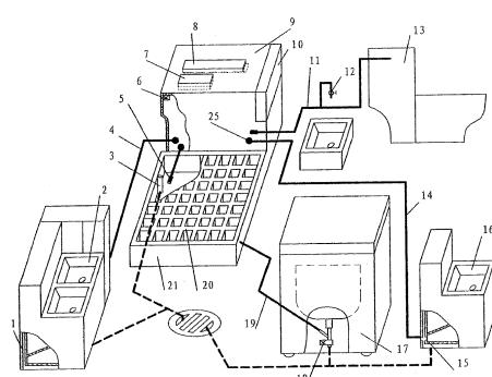
1. 家用节水管道系统，包括位于厨房洗碗池（2）下并与其连通的第一分蓄水箱（1），位于卫生间洗手池（16）下并与其连通的第二分蓄水箱（15），与第一、第二分蓄水箱（1、15）连通的总蓄水箱（9）以及自动控制装置（10），在第一和第二分蓄水箱（1、15）内分别设置有潜水泵（5），该泵的出水管（14）与总蓄水箱（9）连接，其特征是所述总蓄水箱（9）的出水口通过管路（11）与卫生间的冲水装置（13）连接或/和连接有水龙头（12），在洗碗池（2）和洗手池（16）的下水管管路上分别设置有开关阀门（30），所述第一、第二分蓄水箱（1、15）分别包括箱体（23），箱体内设置有高水位出水管（29）和虹吸管（24），所述虹吸管的最高点位于水箱的最高水位和正常水之间，其内管口位于箱底，外管与下水道连通。
