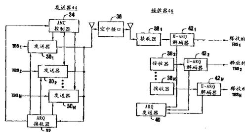
1. 一种用于传递传输时间间隔的数据的基站，使用自适应调制和编码并且具有物理层混合自动重复请求机制，该基站包括：
