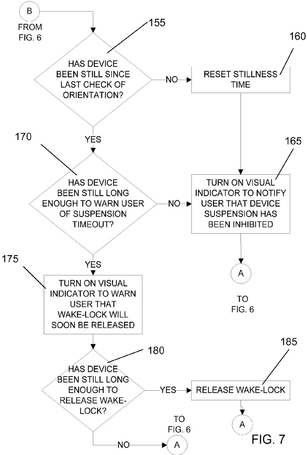
**SYSTEMS AND METHODS FOR MANAGING POWER CONSUMPTION OF MOBILE COMPUTING DEVICES**
