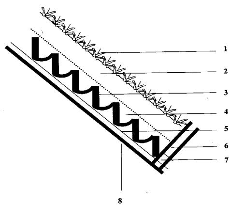
1、一种坡面屋顶草坪，其特征在于包括防水层（5）、坡面屋顶固定盘（3）、水分涵养层（4）、坪床土壤基质层（2）及草坪植物（1），防水层（5）铺设在坡面屋顶（8）上，防水层（5）上面排列铺设坡面屋顶固定盘（3），固定盘（3）呈内凹式的台阶状，固定盘（3）向下的一侧为直面，向上的一侧为向上翘起的弧形面构成凹槽，固定盘（3）上面铺设保水材料覆盖固定盘的弧形凹槽，构成水份涵养层（4），在水份涵养层（4）上面铺设坪床土壤基质层（2），坪床土壤基质层（2）上种植草坪植物（1），排水通道（7）设置在屋檐（6）的低处。
