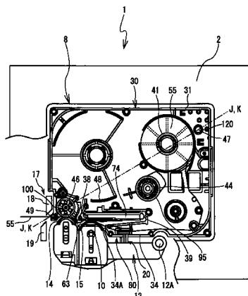
1. 一种带盒，所述带盒被构造成被安装在带式打印机的带盒壳体部分中，所述带式打印机包括引导轴，所述引导轴具有大直径轴部分、小直径轴部分和锥形部分，所述大直径轴部分形成所述引导轴的基端侧，并且所述大直径轴部分在所述引导轴中具有最大直径，所述小直径轴部分形成所述引导轴的前端侧，并且所述小直径轴部分具有比所述大直径轴部分小的直径，并且所述锥形部分连接所述大直径轴部分和所述小直径轴部分，并且所述锥形部分具有锥形形状的倾斜表面，在该倾斜表面中，直径从所述大直径轴部分朝向所述小直径轴部分逐渐地减小，所述带盒包括：
