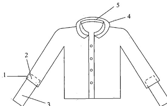
1. 一种易清洁的衣服,其特征在于:衣袖(1)内侧设有夹层(2),夹层(2)边缘同套袖(3)边缘采用拉链连接为一体;领口(4)内侧拉链连接衣领(5)。
