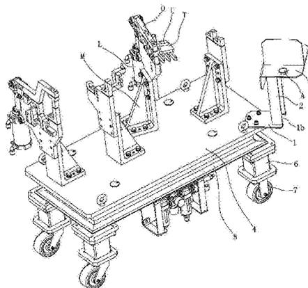
1. 一种面包车焊接工装双压紧装置,其特征在于:平台(4)由底框(5)支撑,该底框(5)为方框结构,在底框(5)底部的四个角处均设置有增高座(6),所述增高座(6)的顶面固定支撑底框(5)对应角的底面,在每个增高座(6)的下方安装滚轮(7),底框(5)下方的四个滚轮(7)其中两个为万向轮,另外两个为定向轮;
