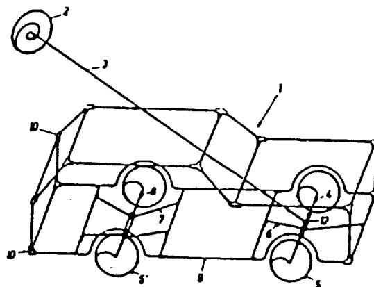
Die Erfindung betrifft ein Spielfahrzeug mit einer aus dem Fahrzeug ragenden, mit der Vorderachse des Fahrzeugs verbundenen biegsteifen Lenksäule mit Lenkrad.
