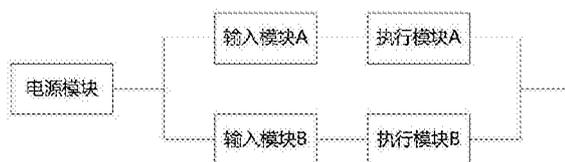
1. 一种安全转矩关断电路,包括电源模块、输入模块A、输入模块B、执行模块A、执行模块B以及STO诊断模块;其特征是:
