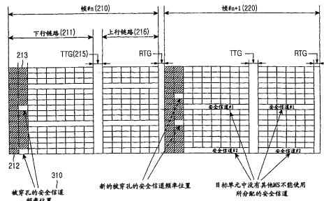
1、一种用于在正交频分多址(OFDMA)系统中将频率分配给在移交操作中的用户台(SS)的方法，该方法包括步骤：
