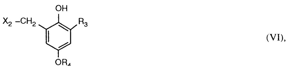
worin  $X_2$  Halogen,  $R_3$  Halogen und  $R_4$  Niederalkyl ist, mit einer Verbindung der Formeln VIIa, VIIb oder VIIc
