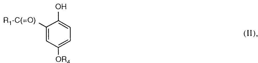
worin R<sub>1</sub> Hydroxy oder Niederalkoxy und R<sub>4</sub> Niederalkyl bedeutet, oder ein Salz davon durch Behandlung mit elementarem Halogen in einem Niederalkanol in m-Stellung zur R<sub>1</sub>-C(=O)-Gruppe halogeniert, wobei Carboxy R<sub>1</sub>-C(=O)-, sofern vorhanden, zu Niederalkoxycarbonyl verestert wird und/oder
